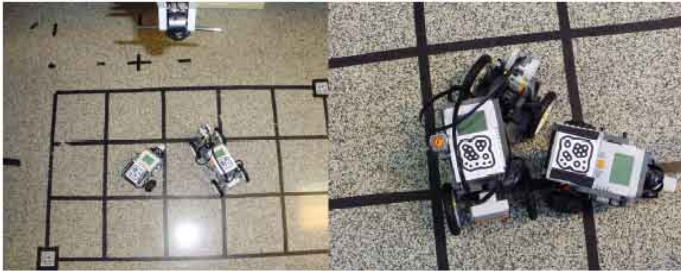
Fig. 1. El sistema LEGO Mindstorms. Izquierda: Dos robots en el área de trabajo. La cámara se observa en primer plano (arriba). Derecha: detalle de los dos robots con los marcadores de reactIVision.
