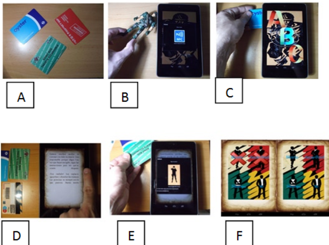
Figura 2. Funcionamiento del juego (a) se buscan las tarjetas que contengan el chip NFC en su interior. (b) Se asocian los objetos con su significado en el libro-juego (c) Se asocian las tarjetas (d) lectura común del libro digital (e) toma de decisiones a través de los objetos físicos (f) Final del juego
